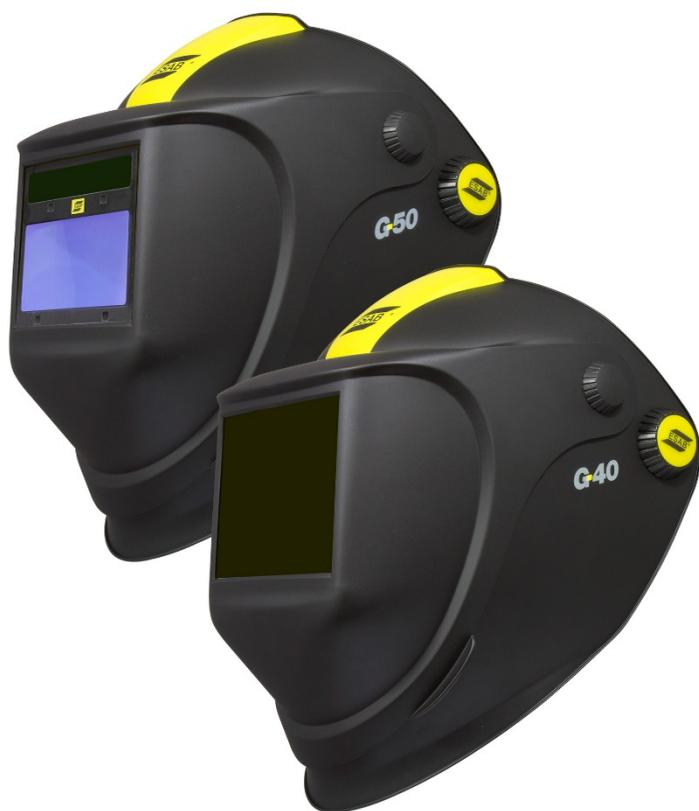
La G40 y G50 es una pantalla combinada de soldadura y amolado; la G40 incluye un cristal mineral pasivo y, la G50, un filtro de oscurecimiento automático (ADF), niveles de oscurecimiento DIN 9-13 y una visera abatible. La lente de plástico grande ofrece al soldador un campo de visión completo cuando la visera está plegada hacia arriba. Las pantallas disponen de la puntuación B en la clasificación de resistencia al impacto, lo que significa que están homologadas para ser utilizadas en el amolado.
